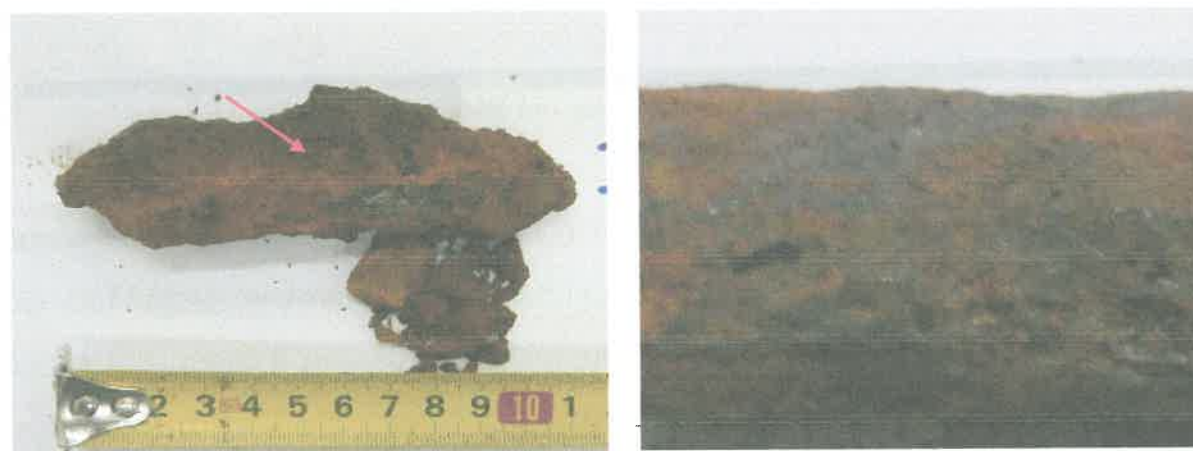
Εικόνα 16: "Δείγμα 3α" γεώδους υλικού από την επιφάνεια της σωλήνωσης
