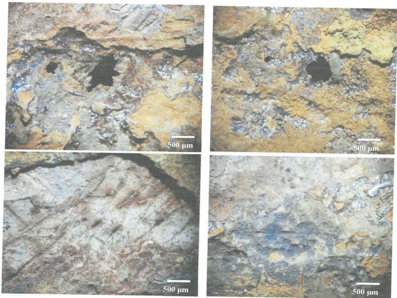
Εικόνα 18: Επιφανειακές μακρογραφίες στερεοσκοπίου "Δείγματος 1" – Περιοχή Διάτρησης
