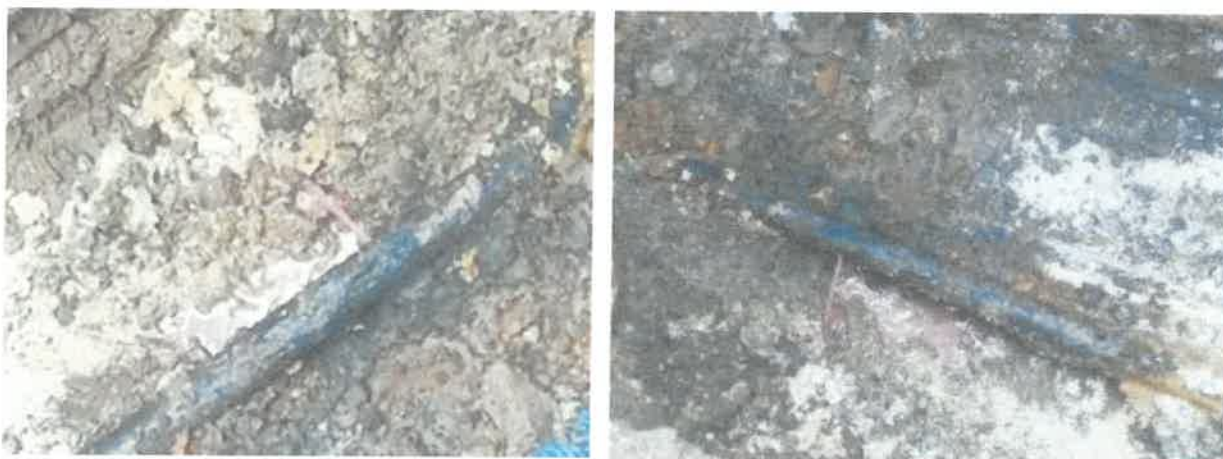
Εικόνα 2: Αυτοψία στον αύλειο χώρο του εργοστασίου «ΒΙΟΛΑΝΤΑ Α.Ε.». Ανίχνευση διατρήσεων-διαρροής μέσω αύξησης πίεσης με μηχανική αντλία νερού
